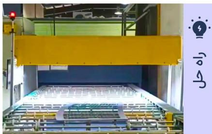
استفاده از سخت افزار بینایی ماشین جهت تشخیص هوشمند عیوب، هشدار آنی و اجکتور
